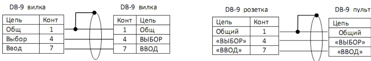
Рис.1. Схема соединения разъемов кабеля пульта.
