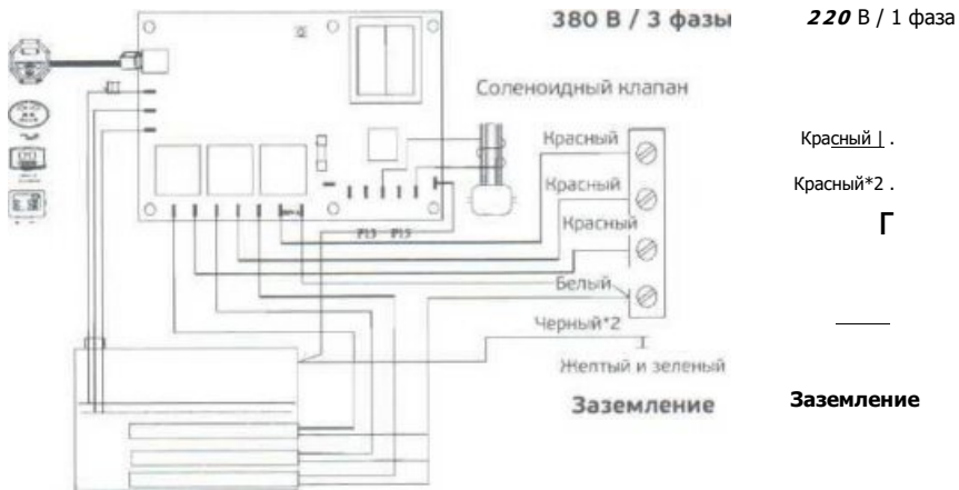
Рисунок 1. Схема подключения парогенератора
