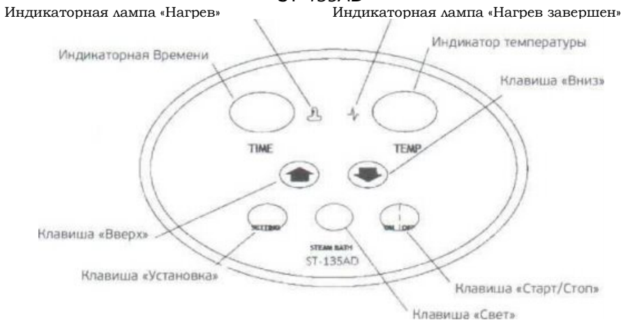
Рисунок 3. Указания по установке контроллера температуры ST-135AD
