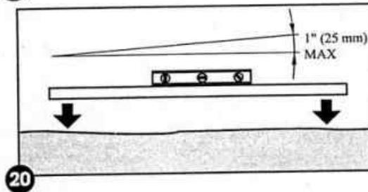
**е.** Не подсыпайте для выравнивания свежий грунт. Это ослабляет безопасность фундамента бассейна. Допускается заполнение небольших ямок и впадин, но после этого земля должна быть сильно утрамбована при помощи инструмента для утрамбовки.
