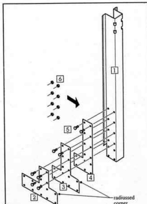
в. Закрепите одну вертикальную стойку (№1) с крепежкой на удерживающей пластине используя три длинных болта 3/4" (№21) и гайки (№10). Проверьте, чтобы основание стойки было полностью прикреплено к крепежке. Основание стойки имеет три больших отверстия для фиксирования стойки к крепежке.
