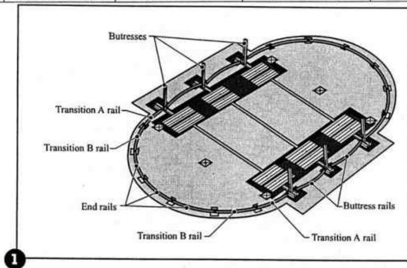
Бассейн, размер которого 18x33 имеет все 4 типа поручней. На рисунке 1 показано расположение каждого поручня.
